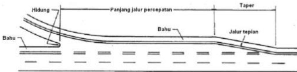
Gambar 2.27 Lajur Percepatan Tipe Paralel
