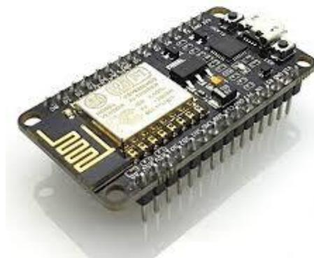
Gambar 2. 6 NodeMCU ESP8266
