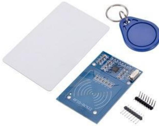
*Gambar 1.4. RFID RC522 (Tag dan Transceiver)*
