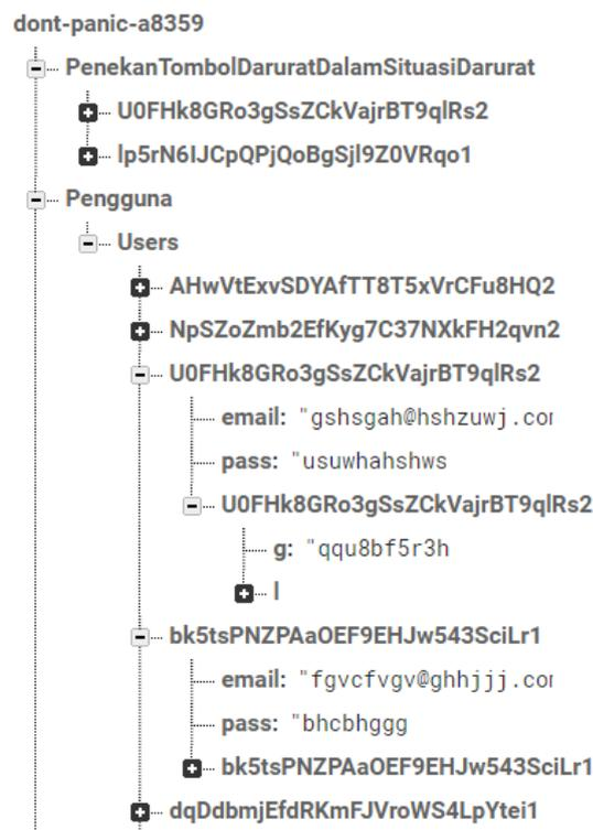
Gambar 2.2 Struktur Firebase Realtime Database
