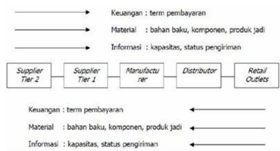
Gambar 1. Proses supply Chain dan 3 macam aliran yang dikelola
