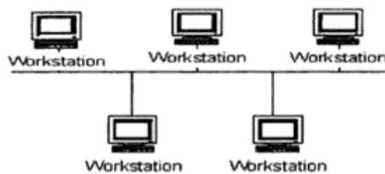
Gambar II.4 Ilustasi Untuk Topologi BUS
