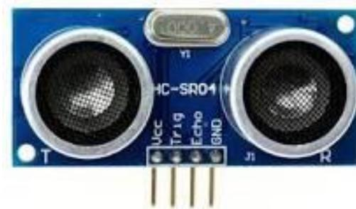
*Gambar 2.5 Bentuk Sensor Ultrasonic HC-SR04*
