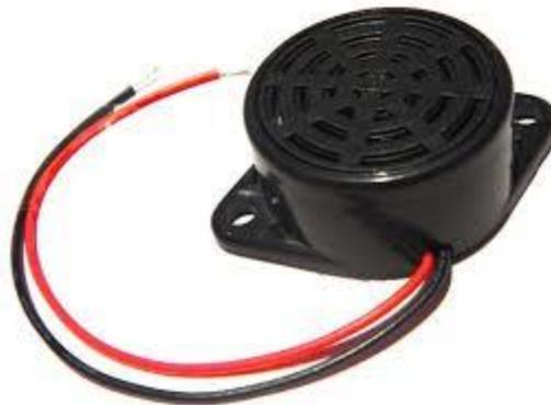
*Gambar 2.11 Bentuk Buzzer*
