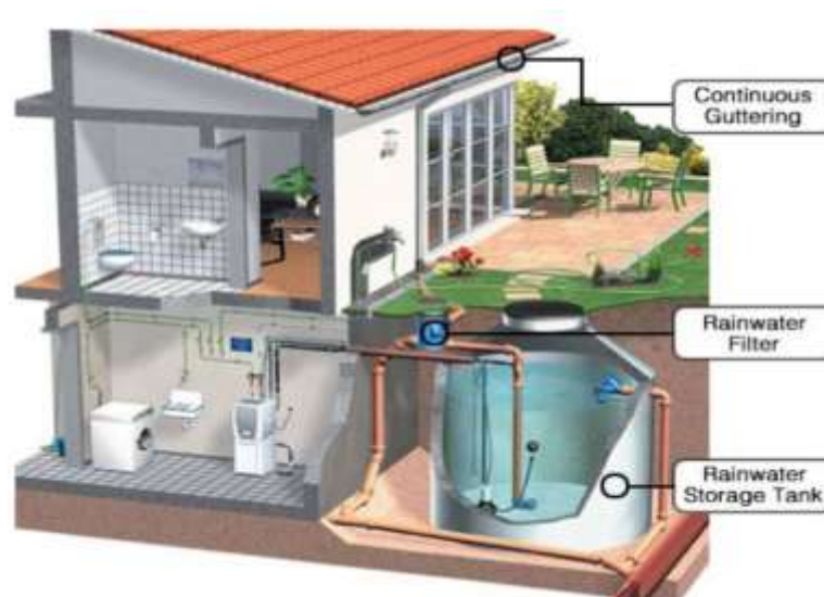
Gambar 2. 4 Rainwater Harvesting Dengan Tangki Di Dalam Tanah
