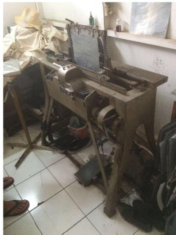
**Gambar 2.16** Mesin Tik Braille (*Stereo Typer*)
