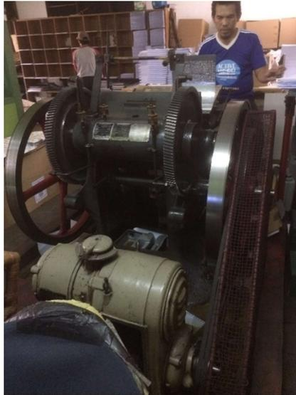
**Gambar 2.17** Mesin Cetak Braille (Mesin Press Braille)
