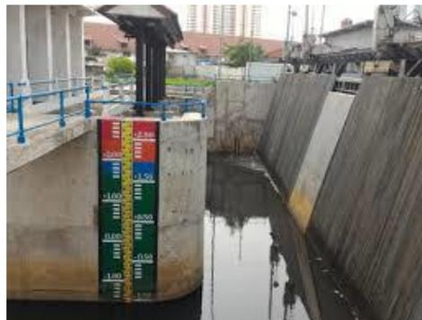
Gambar II.5. Water Leveling Scale pengamatan visual.
