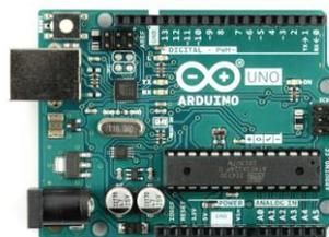
Gambar II.7 Mikrokontroler Arduino Uno R3 ATMega328.
