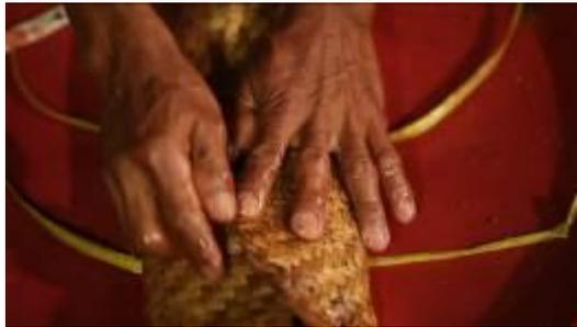
Gambar II.5 Proses dimasukan cetakan (*sawuk*) dan di *press*
