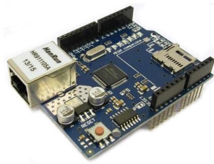
Gambar 2.8 Bentuk Ethernet Shield
