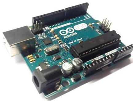
Gambar 2.6 Bentuk Arduino Uno
