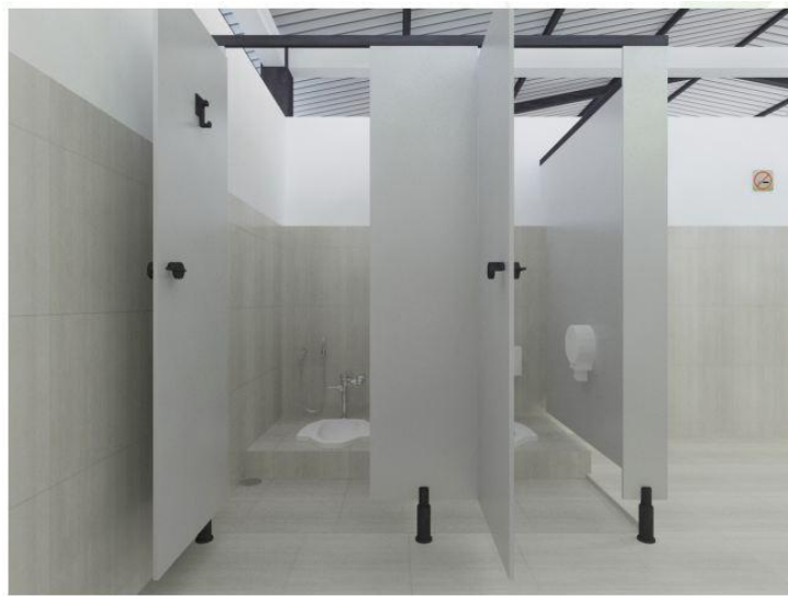
Gambar 4: Desain Toilet Tipe Standar (Kubikal / Bilik Toilet) Wanita dan Pria Sumber: Asosiasi Toilet Indonesia (ATI) : (2007)
