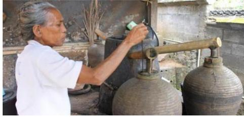
*Gambar 2. 4 rangkayan alat pengarakan atau destilasi*
