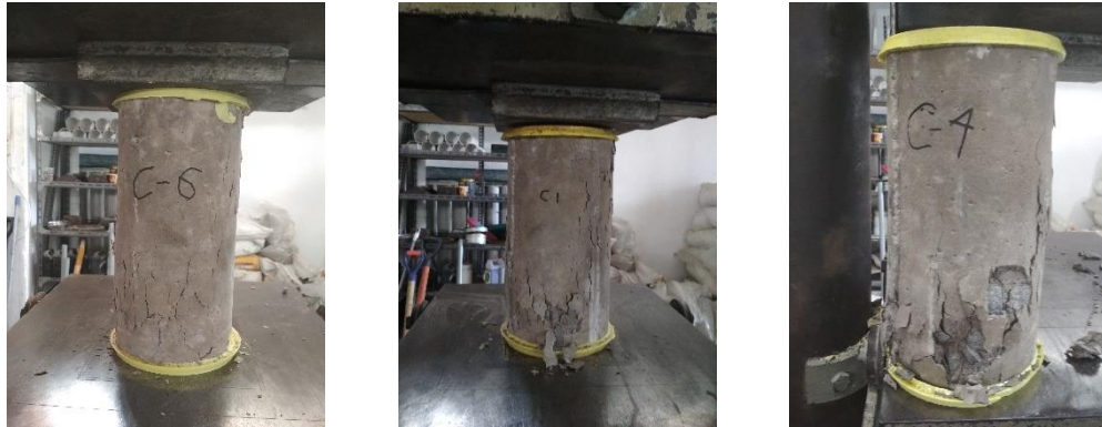
Gambar 4. 2 Beton setelah ditekan
