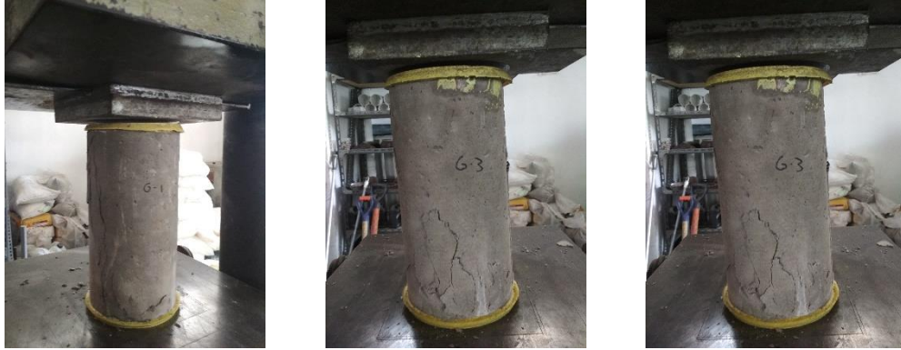
Gambar 4. 4 Beton dengan pasir galunggung setelah diuji tekan
