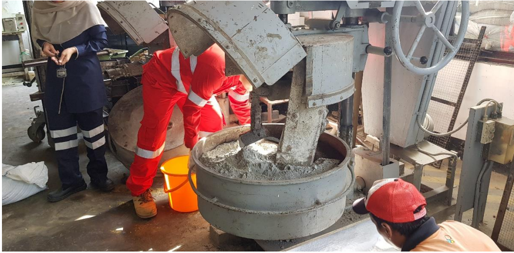
Gambar 4. 2 Proses Pencampuran Beton Normal
