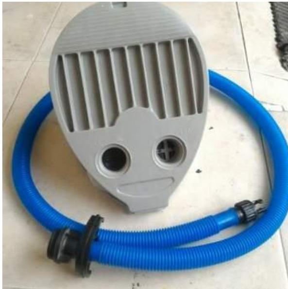
Gambar : 2.3 Pompa Perahu
