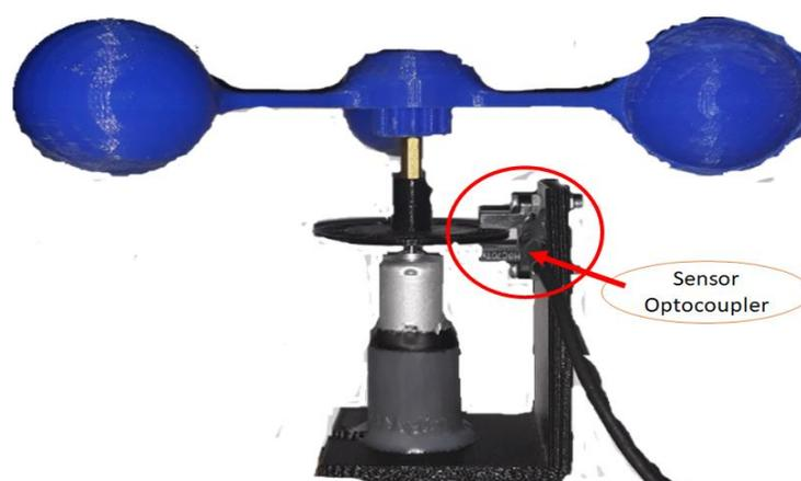
Gambar 1.2 Sensor optocoupler
