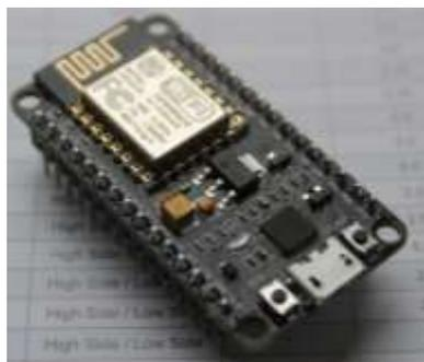
*Gambar III.6 Modul ESP8266 Nodemcu bagian atas*
