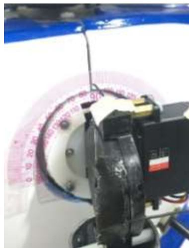
Gambar IV.3 Penempatan busur derajat pada bahu dalam
