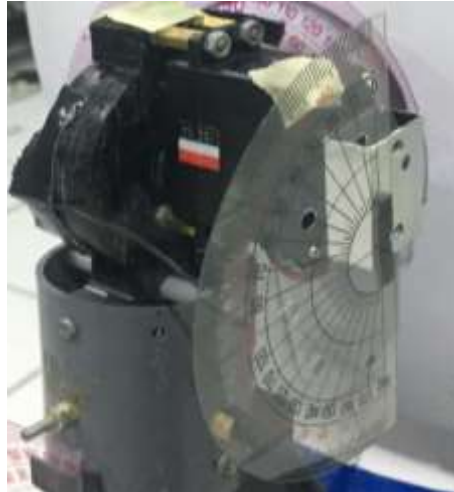
Gambar IV.4 Penempatan busur derajat pada bahu luar
