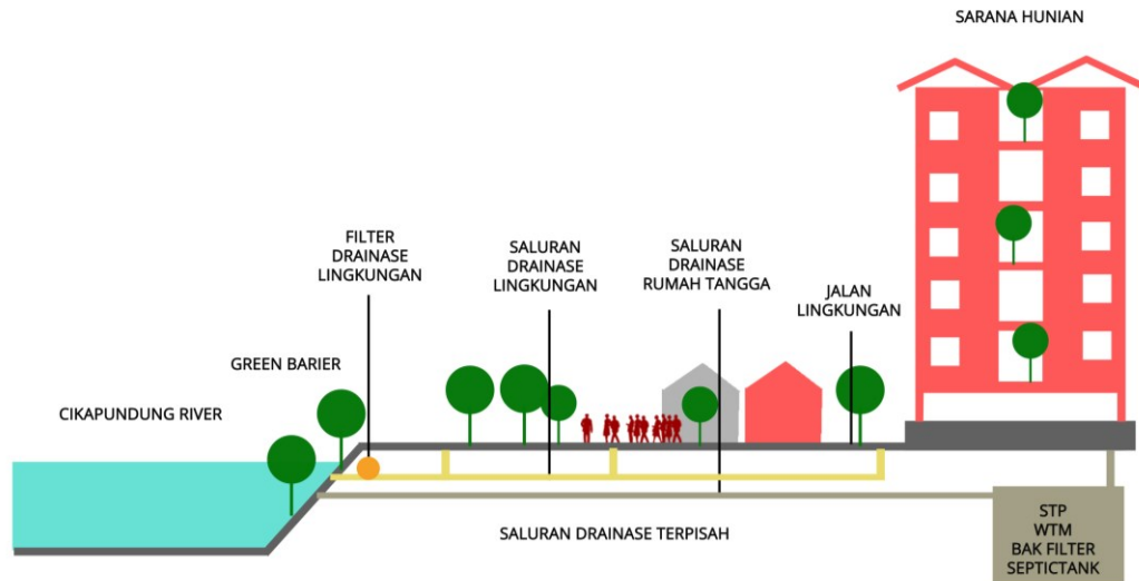
Gambar 5.11. Ilustrasi Skema Utilitas Permukiman Babakan Ciamis RW 03
