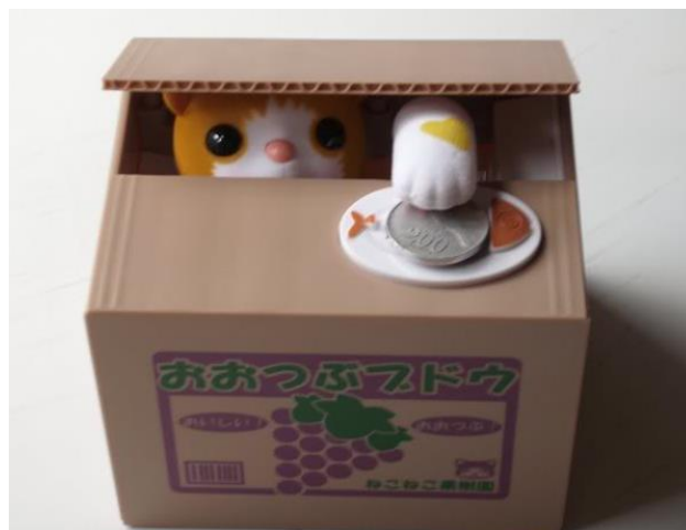
Gambar II.11 Celengan Inovasi yang Dilengkapi dengan Sensorik yang Memudahkan Karakter Menjadi Bergerak Ketika Uang Logam Terdeteksi pada Bagian Tertentu
