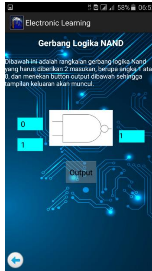
Gambar IV.28 Hasil input dan output gerbang logika nand
