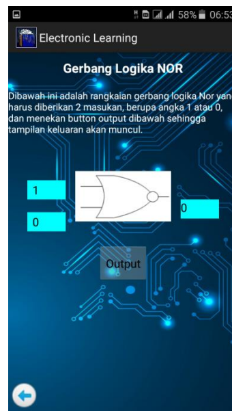
Gambar IV.30 Hasil input dan ouput gerbang logika nor
