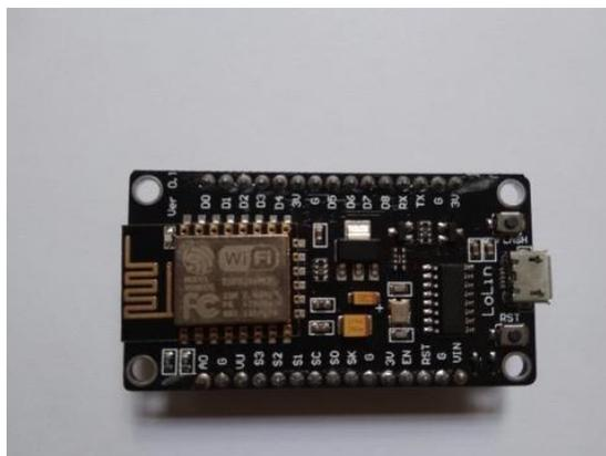
**Gambar 2.7 NodeMCU Esp8266V3 [12]**
