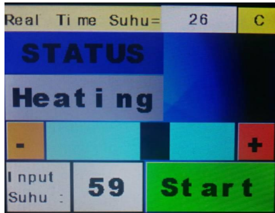
Gambar 4.2 Status ketika memanaskan air di dalam heater (heating)
