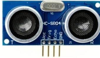
*Gambar 2.4 Modul Sensor Ping*
