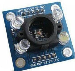
*Gambar 2.3 Sensor Warna TCS3200*
