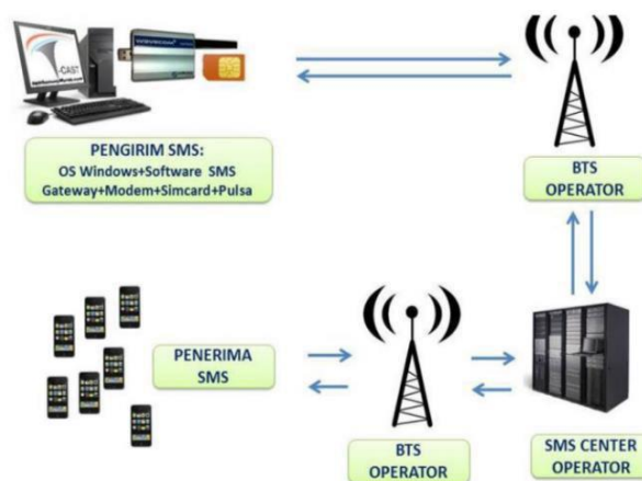
Gambar 2.9 Cara kerja SMS Gateway
