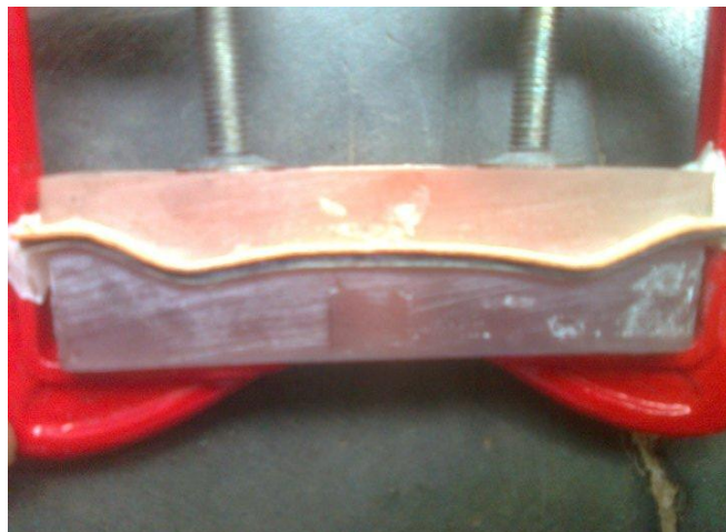
Gambar 2.4 Pembentukan dan Pengeleman Menggunakan Mal dan Clamp C . (Dokumen pribadi)
