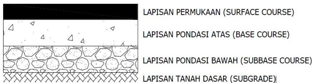
Gambar 2.1. Susunan Konstruksi Perkerasan Lentur
