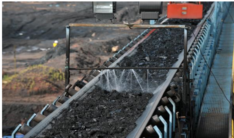
Gambar 2.1 pengangkutan beban secara kontinu
