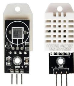
**Gambar 2.22 Sensor DHT 22 [11]**
