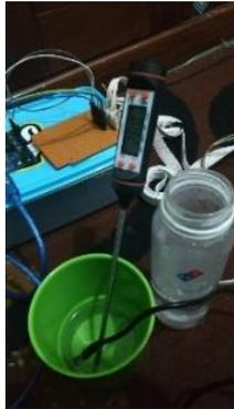
**Gambar 9** Pengujian Sensor Suhu DS18B20
