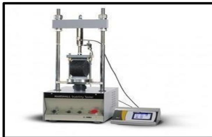
**Gambar 2. 13** Alat Uji Marshall
