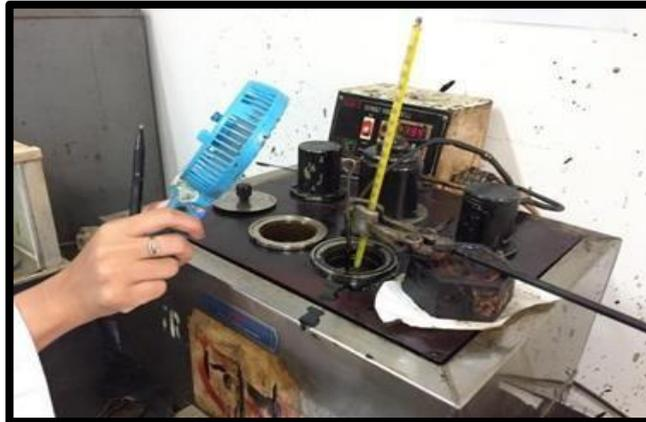
**Gambar 2. 9** Alat Pengujian Viskositas
