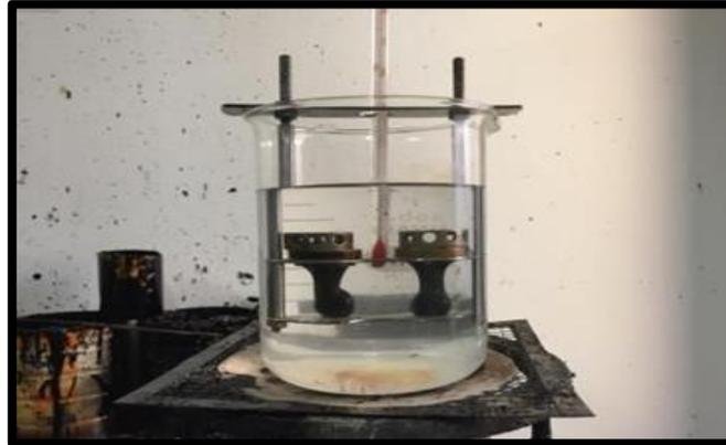
**Gambar 2. 5** Alat Pengujian Titik Lembek Aspal
