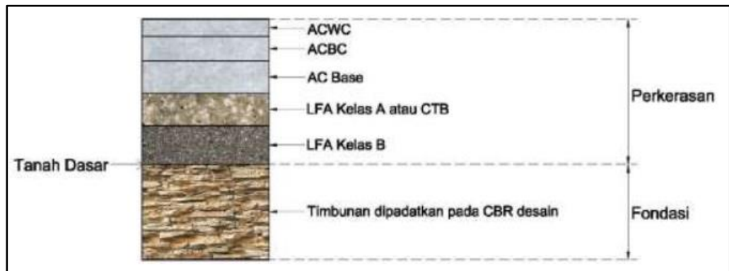
Gambar II. 2 Struktur perkerasan lentur pada timbunan
