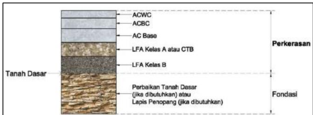
Gambar II. 3 Struktur perkerasan lentur pada galian
