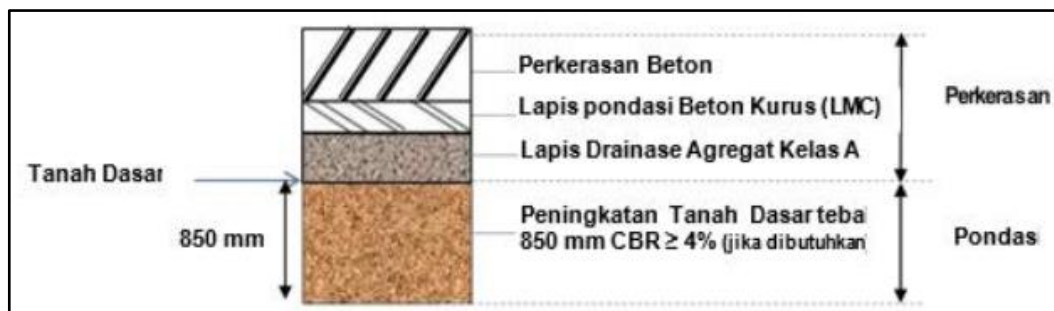
Gambar II. 6 Struktur perkerasan kaku pada galian
