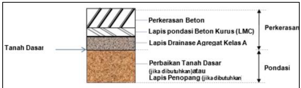
Gambar II. 4 Struktur perkerasan kaku pada tanah asli
