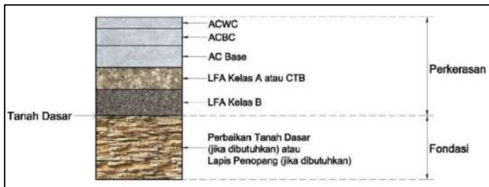
Gambar II. 1 Struktur perkerasan lentur pada tanah asli
