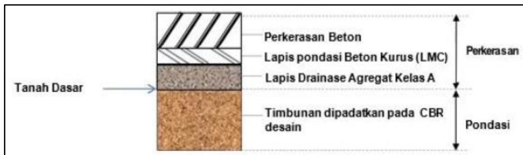
Gambar II. 5 Struktur perkerasan kaku pada timbunan
