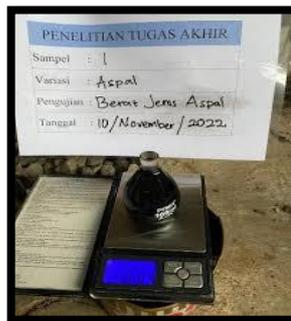
**Gambar 2.5 Pengujian Berat Jenis Bitumen**
