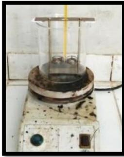
**Gambar 2.4 Pengujian Titik Lembek Aspal**
