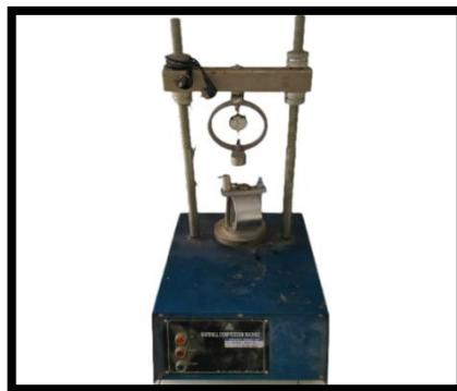
**Gambar 2.14 Alat Pengujian Marshall**
