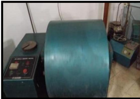
**Gambar 2.10 Pengujian Keausan Agregat**
