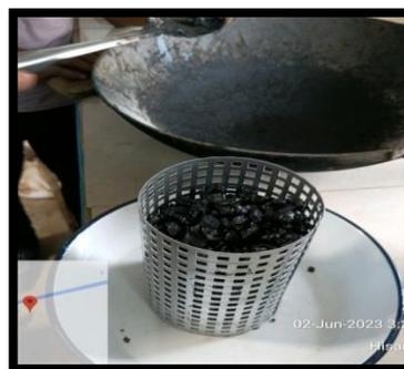
**Gambar 2.16 Keranjang Drain down**
