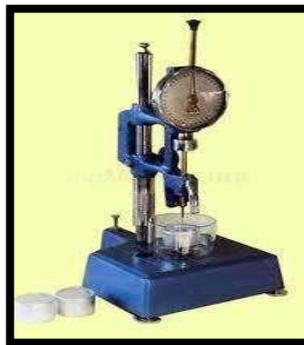
**Gambar 2.3 Alat Pengujian Penetrasi**
