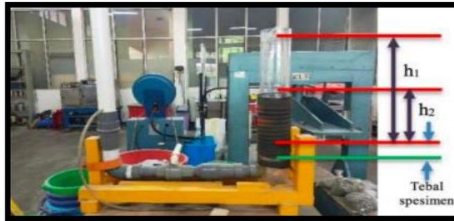
**Gambar 2.15 Pengujian Permeabilitas**
