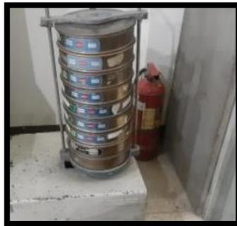
**Gambar 2.9 Analisis Saringan Agregat**
