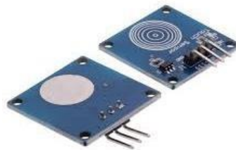
Gambar 2.3 Tampilan Sensor Sentuh TTP223B
