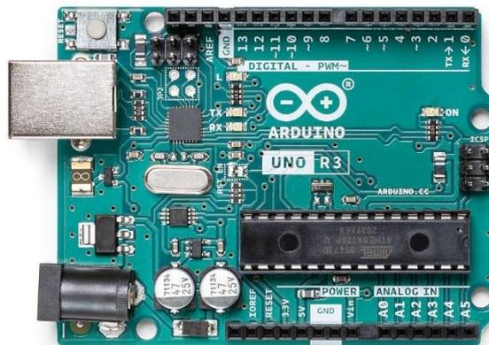
Gambar 2.1 Mikrokontroler Arduino UNO
