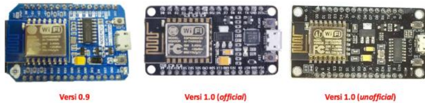
Gambar 2..2 Versi-versi NodeMCU ESP8266
