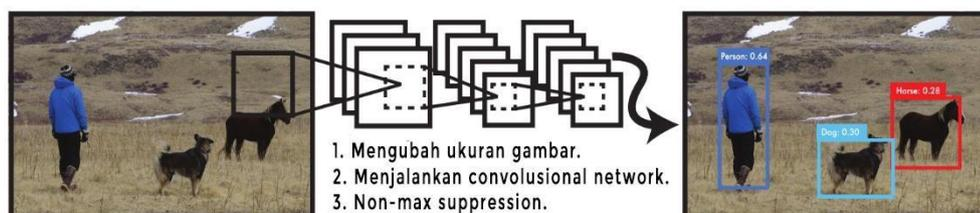
**Gambar 2. 6 Proses Sistem Deteksi YOLO**
