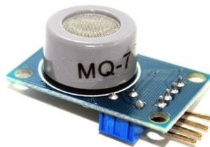
**Gambar 2. 4 Sensor MQ-7 (Adaptasi dari [50])**
