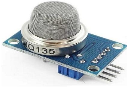
**Gambar 2. 3 Sensor MQ-135 (Adaptasi dari [49])**
