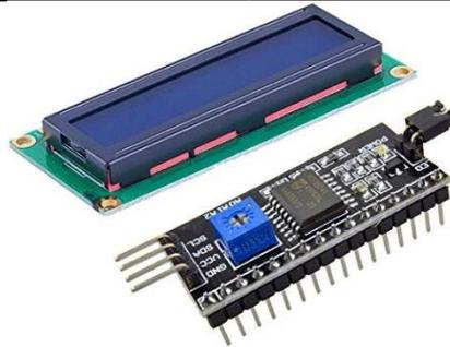
**Gambar 2.12** LCD *display* dan modul I2C
