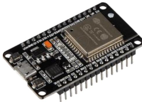
**Gambar 2.2** Mikrokontroler ESP32
