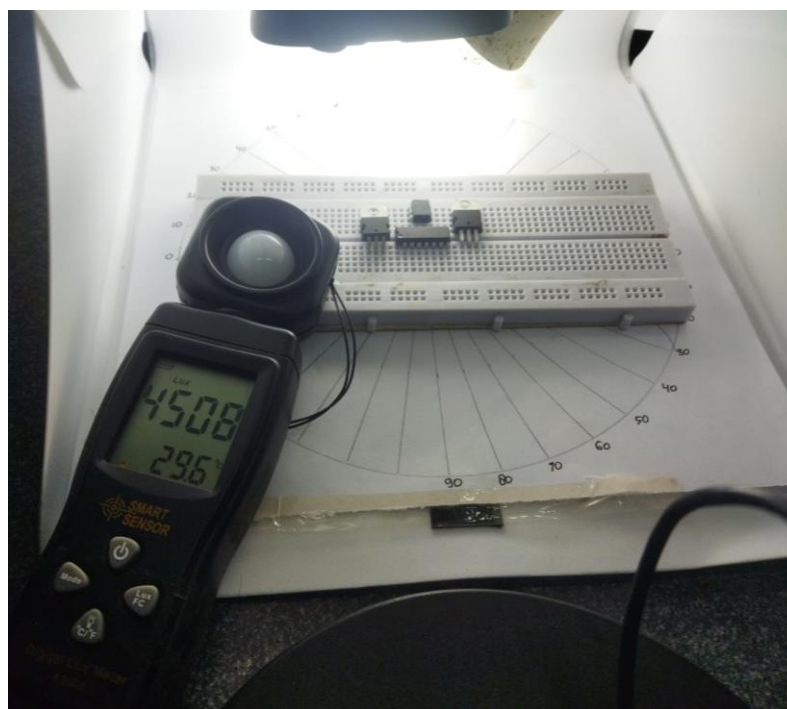
Gambar 2.10 Kalibrasi intensitas cahaya menggunakan lux meter
