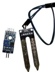
Gambar 2.6 Tampilan Sensor Kelembaban Tanah
