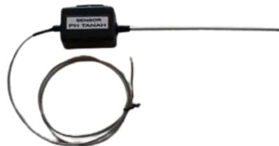
Gambar 2.7 Tampilan Sensor pH Tanah
