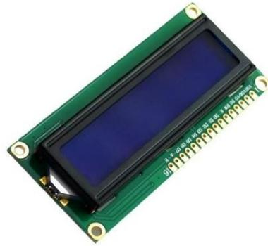
Gambar 2.3 LCD 16x2
