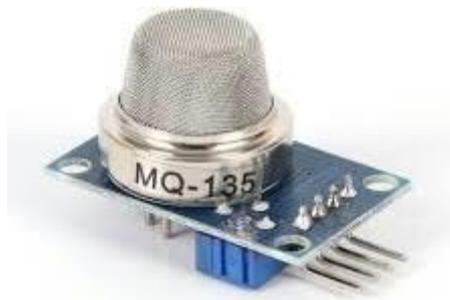
Gambar 2. 4 Tampilan fisik sensor gas MQ-135
