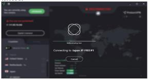
**Gambar 21** ProtonVPN Tidak Bisa Terkoneksi Setelah Mengaktifkan Firewall L7 Protocols Mikrotik
