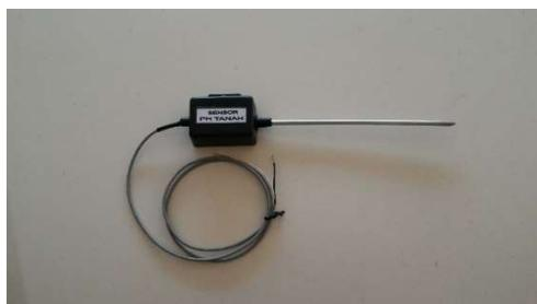
**Gambar 2-14. Sensor pH Tanah**
