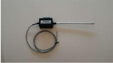
Gambar 4. Sensor pH Tanah
