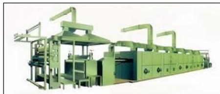
**Gambar 4.11. Mesin *stenter*
